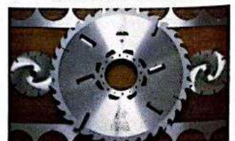
Sierra circular: ranura de tensión y espacios de ranuras
