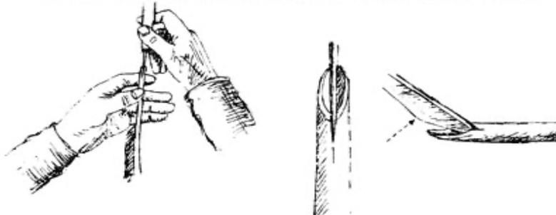
Paso 4.-Recortar un poco la punta para que no quede tan afilada, y limar el corte diagonal hasta poco más o menos la mitad.
